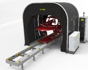
トンネル型インライン 塗装欠陥検査システム
