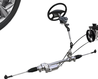
電動パワー ステアリングシステム
