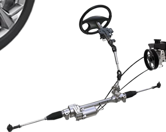
電動パワー ステアリングシステム
