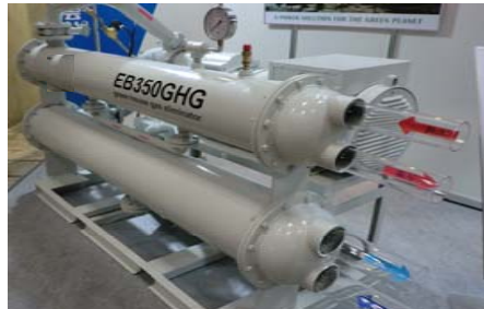
小型バイナリー発電設備
